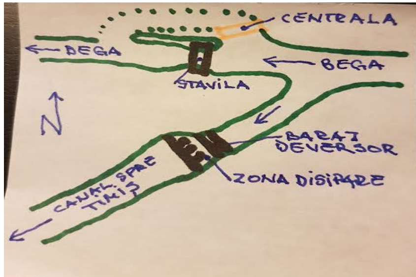
Fotografia 6.9. Schița planimetricii nodului Topolovățul Mic, pe Bega, și devierea către Timiș.
