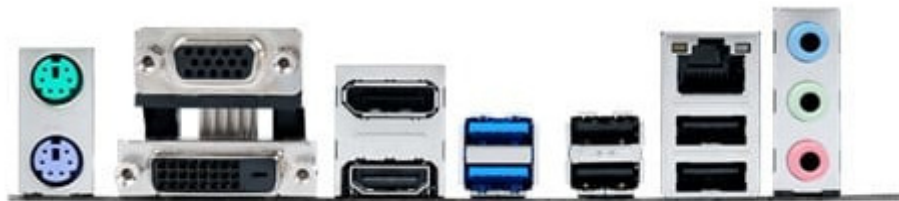
Fig. 1.11. Poturi placă de bază [14]
