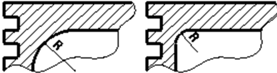
Figura 1.4 Racordarea între capul pistonului și regiunea port segment
